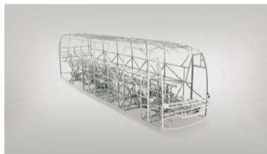
Columna tubular absorbente de energía con estructura anti-colapso, reduciendo la resistencia al impacto de manera efectiva.
